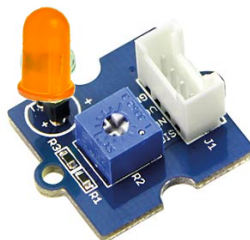
Led orange branchée sur D3
