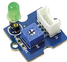
Led verte branchée sur D2
